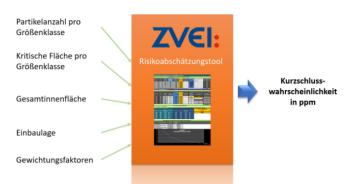
Derzeit finden sich in Bauteilspezifikationen oft Partikelgrenzwerte, die vom kleinsten elektrischen Abstand zwischen zwei stromführenden Bereichen abgeleitet sind. Dies führt dazu, dass extrem scharfe Anforderungen zugrunde liegen, die einerseits technisch und wirtschaftlich nicht umzusetzen sind und andererseits für das Risiko der Baugruppe in Richtung elektrischem Kurzschluss nicht notwendig sind.
